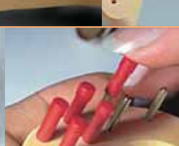
15 Jet-Hülsen über Jetpins stecken. Put sleeves over Jetpins.
