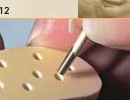
12 Jetpins mit sehr wenig Sekundenkleber einkleben oder nur stecken ohne Kleber. Fix Jetpin either with little glue or fix them just under light pressure.
